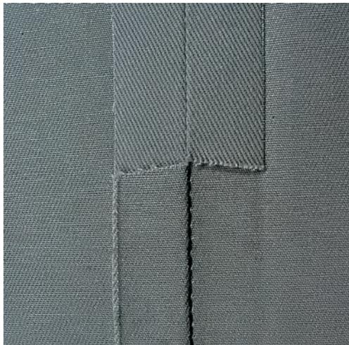
Трехстежковая прямая строчка особенно подходит для износостойких швов и для жестких и плотных тканей, таких как джинсовая ткань и вельвет. При работе с жесткими или очень плотными тканями рекомендуется вставлять джинсовую лапку № 8 (специальная принадлежность). Это облегчает работу с джинсовыми тканями или парусиной. Для декоративного простегивания можно дополнительно увеличить длину стежка.
