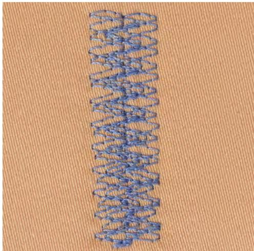
Программа штопки № 34 особенно подходит для поврежденных мест на тяжелых или плотных тканях, например, на джинсах или на рабочей одежде.
