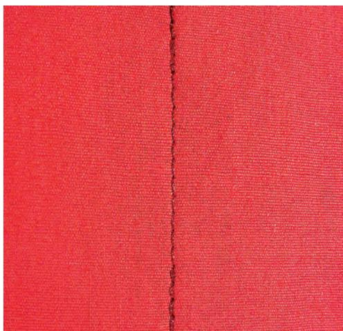
Происходит равномерное закрепление определенным количеством выполненных стежков 5 вперед и 5 назад.
