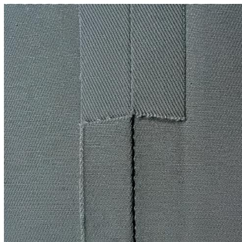
Трехстежковая прямая строчка особенно подходит для износостойких швов и для жестких и плотных тканей, таких как джинсовая ткань и вельвет. При жестких или очень плотных тканях рекомендуется устанавливать джинсовую лапку #8. Это облегчает работу с джинсовыми тканями или парусиной. Для декоративного простегивания можно дополнительно увеличить длину стежка.
