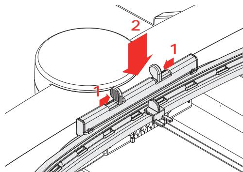
> Чтобы снять пяльцы, сожмите прижимные рычажки устройства закрепления пялец.
