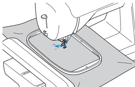
**7** Снимите нить первого цвета с машины. Заправьте в машину нить следующего цвета.
