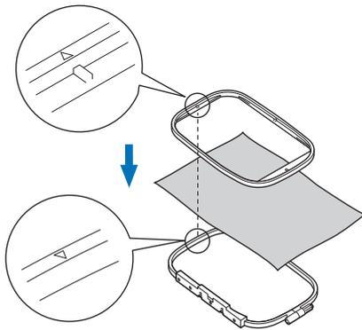
**4** Вручную затяните регулировочный винт ровно настолько, насколько нужно для удержания материала.
