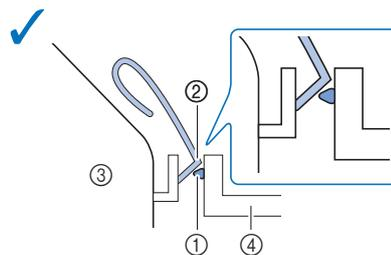
Выступ (①) неплотно заведен под изгиб фиксатора (②).
