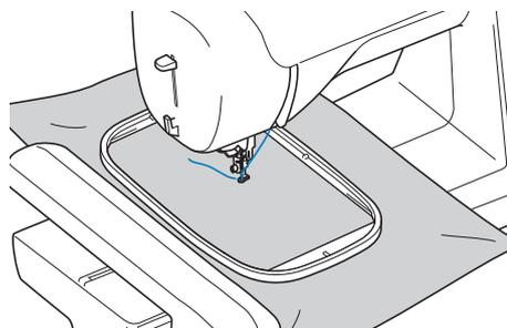
**5** В конце шва обрежьте излишек нити. Если конец шва находится под прижимной лапкой, поднимите лапку, а затем обрежьте излишек нити.
