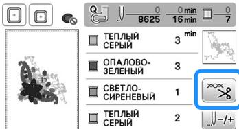
2 Для выключения функции автоматической обрезки нити нажмите кнопку
