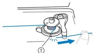
① Направляющая прорезь в седле устройства намотки шпульки (со встроенным устройством обрезки нити)
